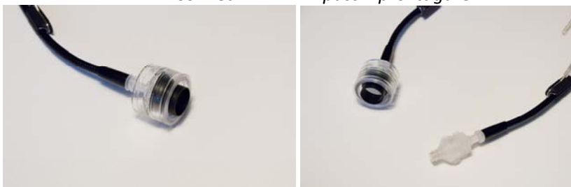
25 mm kassett modifierad för inhalerbart damm och 13 mm Swinnexkassett
